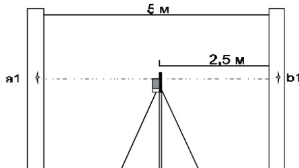
Установить лазерный нивелир на расстоянии 0,5-0,7м от стены и нанести, как указано выше, те же отметки. Если разности {a1-a2} и {b1-b2} не отличаются друг от друга более чем на величину „точность”, заявленную в технических характеристиках, точность лазерного нивелира в допустимых пределах.
