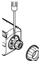
Когда разница между теоретическим и действительным показанием составляет больше 3 мм, линия визирования должна быть отрегулирована.
