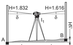
При расположении в центре и о трегулированном пузырьке круглого уровня, линия визирования должна быть горизонтальной.
