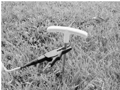
Рис. 8: Подсоединение провода к заземляющему штырю
