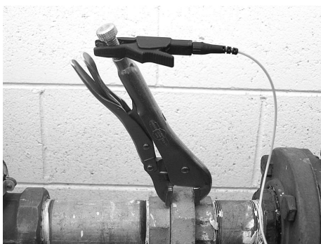
Рис 10: Вариант подсоединения к трубопроводу
