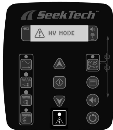
Рис. 20: Индикатор высокого напряжения
