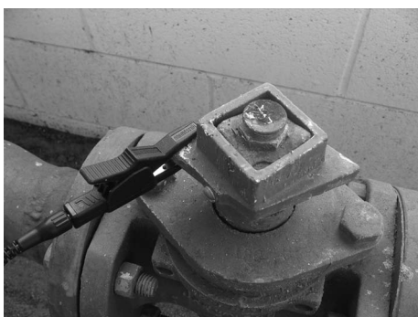
Рис. 9: Пример подсоединения к газовой магистрали
