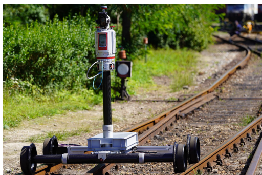
RIEGL VMR: проведение съемки в режиме Stop & Go на испытательной трассе в Нижней Австрии
