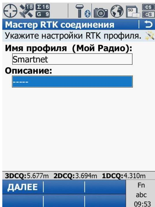
**3.** Далее контроллер предлагает выбрать канал, по которому приемник будет принимать поправки от сетей базовых станций. Т.к. RTK поправки от сети базовых станций SmartNet передаются на GNSS-приемник через интернет, выбираем из списка соответствующий пункт (**Интернет (NTRIP)**).
