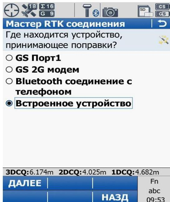
Аббревиатура GS обозначает приемник, CS – контроллер.
