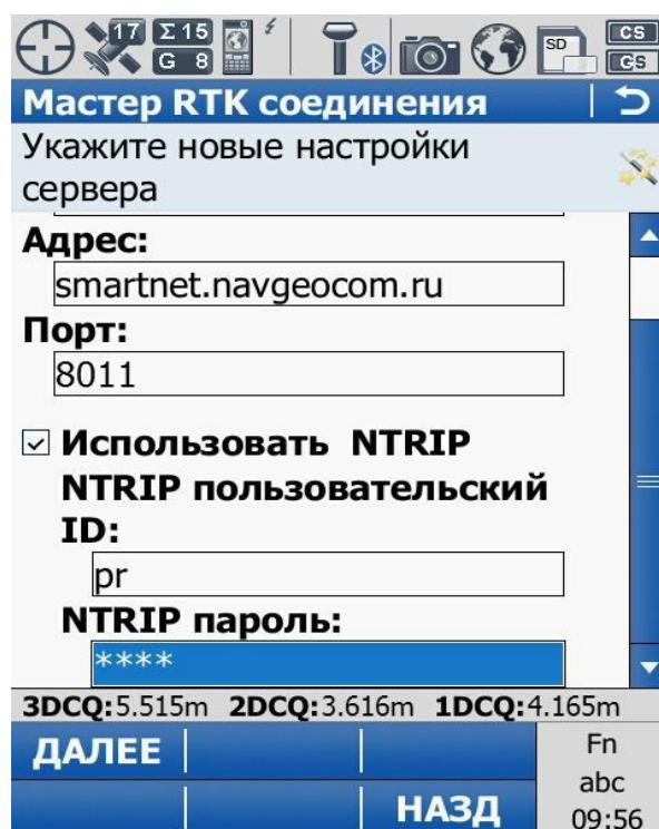
**12.** После создания сервера необходимо определить точку доступа (Mounting point), т.е. выбрать одиночную базовую GNSS станцию, или сетевое решение, от которого будут поступать RTK поправки. Точку доступа необходимо выбрать из списка доступных на сервере через меню «**Укажите точку стояния из списка**». Точки доступа можно посмотреть на карте в разделе «Зона покрытия» на сайте
