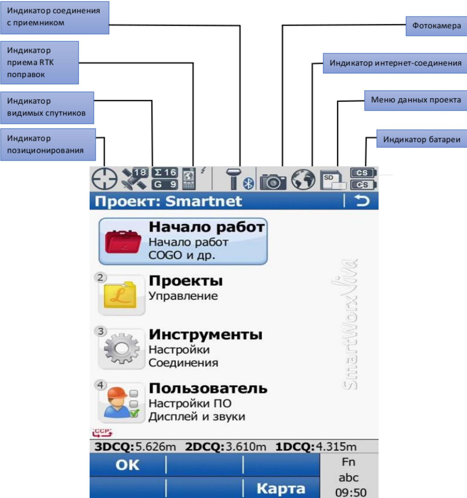
RTK поправки от сети базовых станций SmartNet передаются на GNSS-приемник через интернет.
