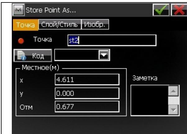
Так как в предыдущем меню была поставлена галка на  Изм. расст., программа вычислила координаты точки ОРП относительно координаты текущей точки стояния прибора. Задаём имя точки ОРП (например: st2) и нажимаем .
