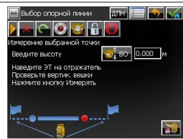
В поле  $\text{ВО}$   $[0.000]$  м водится высота отражателя (если требуется). Наводимся на вторую точку и нажимаем на .
