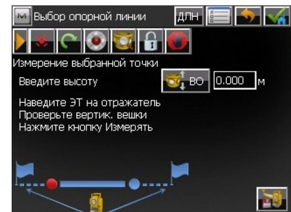
В поле  $\text{ВО}$   $[0.000]$  м водится высота отражателя (если требуется). Наводимся на первую точку и нажимаем на .
