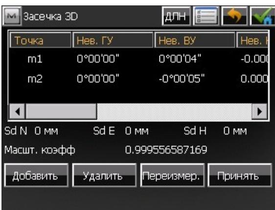
**Шаг 2.** После измерения двух контрольных точек (это минимум для линейно-угловой засечки) программа автоматически вычислит координаты точки стояния прибора.
